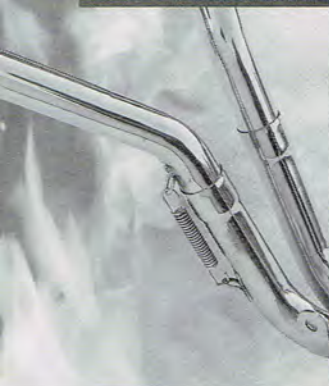
ノーマルマフラーでは7.47psだったエンジンパワーだが、このツインマフラーに交換すると6000rpm付近からパワーカーブが急上昇し8.66psまでアップ。
